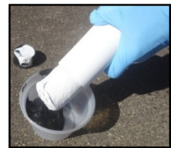
Utilice la vara de mezclador para empujar el epoxi dentro del contenedor. Mezcle bien ambas partes hasta lograr una consistencia gris sólida sin vetas negras o blancas.
