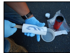
Utilice la vara de mezclador para empujar el epoxi dentro del contenedor. Mezcle bien ambas partes hasta lograr una consistencia gris sólida sin vetas negras o blancas.
