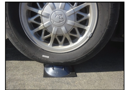
Estacione la rueda de un vehículo sobre la base durante 15 segundos.
