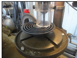
Utilice un taladro de 25/64" para completar los agujeros de entrada en la parte posterior de la base.
