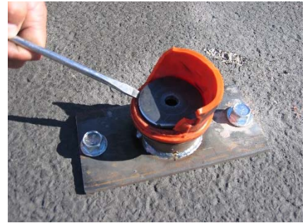
Step 3: Remove hold-down disc.
