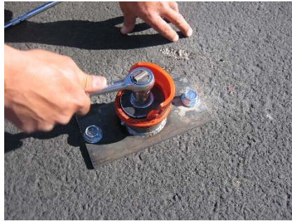
Step 2: Remove 1/2" center bolt.
